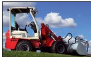
Kabina zamknięta homologowana ROPS-FOPS on PICHON loader
