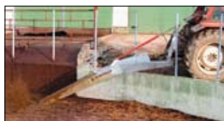
Maszyna do jednofazowego zbioru wierzby krzewiastej
